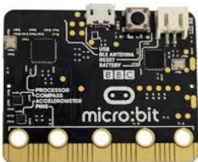
Der Microbit ist ein englischer Minicomputer. Er wird kann wie ein USB Stick über die USB Schnittstelle programmiert werden und hat sowohl Tasten als auch LEDs und weitere Sensoren.
